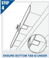
ENSURE BOTTOM TAB IS UNDER TOP CORRUGATION OF ROOFING IRON AS SHOWN
